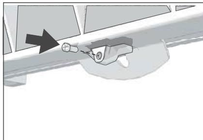
7. Das Gitter mit den beiden Schrauben wieder befestigen.
