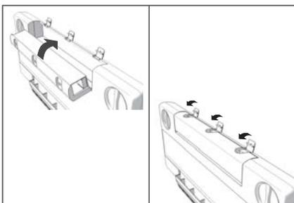
7. Das Filtergehäuse verschieben und mit den drei Verschlussklemmen befestigen.
