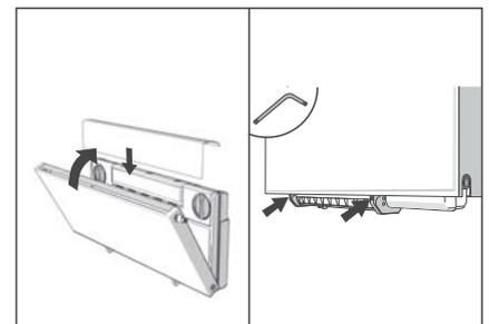
9. Die Abdeckung wieder befestigen und den Radiator schließen. Im Anschluss die beiden Sicherungstifte mit dem Inbusschlüssel festziehen.
