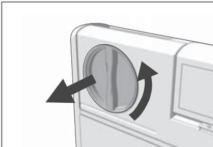
4. Beide Stopfen entfernen, indem Sie diese eine Umdrehung nach links drehen.
