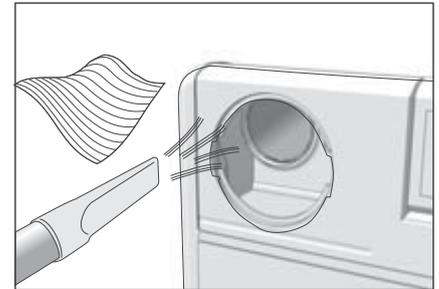
6. Mit einem Staubsauger oder einem weichen Tuch den Schmutz aus beiden Kanälen entfernen (kein Wasser verwenden).
