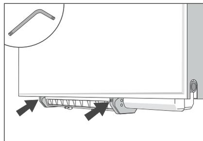
2. Die beiden Sicherungsstifte mit einem Inbusschlüssel nach außen drehen.
