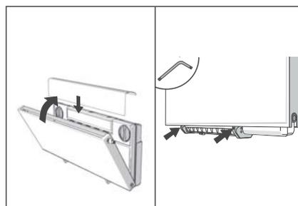
8. Die Abdeckung wieder befestigen und den Radiator schließen. Im Anschluss die beiden Sicherungsstifte mit dem Inbusschlüssel festziehen.
