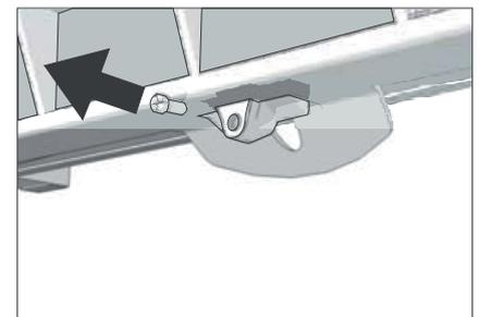
3. Die beiden Schrauben unter der Filterabdeckung losdrehen.
