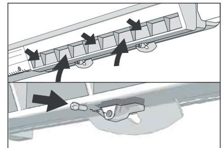
6. Die drei neuen Filterelemente in die Fächer einsetzen und das Gitter an der Unterseite mit den zwei Verschlussklemmen kräftig festdrücken, bis Sie ein Klicken wahrnehmen.
