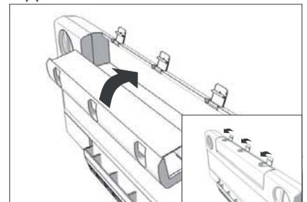
6. Das Filtergehäuse nach oben kippen und mit den drei Verschlussklappen befestigen.
