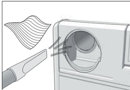
5. Mit einem Staubsauger oder einem weichen Tuch den Schmutz aus beiden Kanälen entfernen (kein Wasser verwenden).
