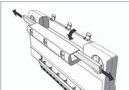
4. Die beiden verschmutzten Filterteile an den Seiten aus dem Filtergehäuse herausschieben.
