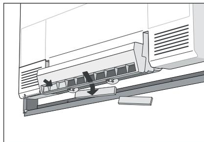
5. Die drei Filterelemente nach hinten schieben, damit sie sich lösen.
