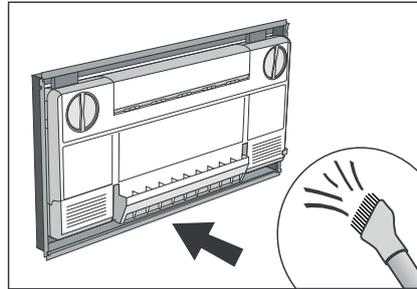
2. Einen Staubsauger verwenden, um so viel Schmutz wie möglich aus dem Filtereinschub an der Unterseite zu entfernen.
