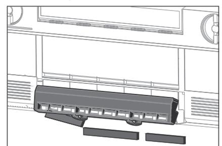
9. Den Filter an der Vorderseite aus dem Filtergehäuse herauschieben. Die drei neuen Filterelemente in die Fächer einsetzen.
