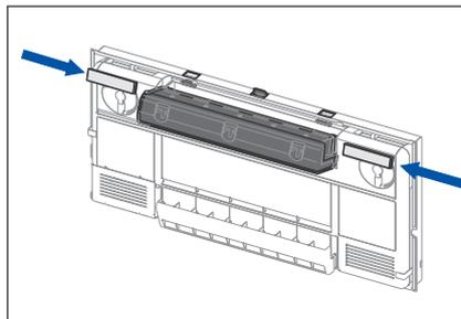
5. Die beiden neuen Filter vollständig in das Filtergehäuse einschieben, sodass sie nicht überstehen.
