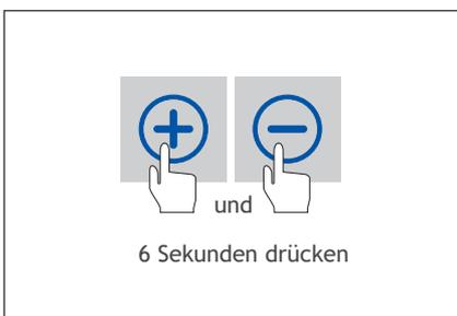
16. Den Stundenzähler des Filters zurücksetzen, indem Sie + und - auf dem Display gleichzeitig sechs Sekunden drücken. Die Meldung „Filter vervuild“ verschwindet nun.
