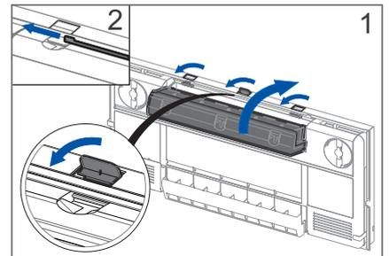
6. 1. Das Filtergehäuse schließen und mit den drei Verschlussklemmen verriegeln. Vorsicht! Die Filter dürfen nicht aus dem Filtergehäuse herausstehen. 2. Die Abdeckung nach links zuschieben.
