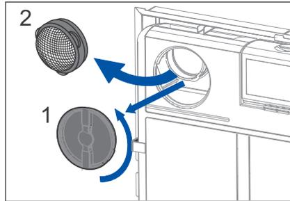
11. **Reinigen der Luftkanäle.**
