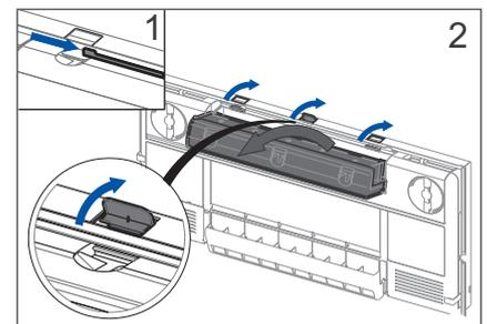
3. Wechseln der Zufuhrfilter. 1. Die Abdeckung nach rechts schieben, nun sind die Verschlussklemmen zu sehen. 2. Die drei Verschlussklemmen an der Oberseite öffnen und das Filtergehäuse nach vorne kippen.
