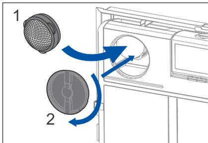
13. Die runden Einsätze wiedereinssetzen. Die beiden Inspektionsluken wiedereinssetzen und gut verschließen, damit das Gerät ordnungsgemäß funktioniert.
