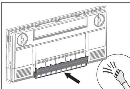
7. Reinigen der Abfuhrfilter
