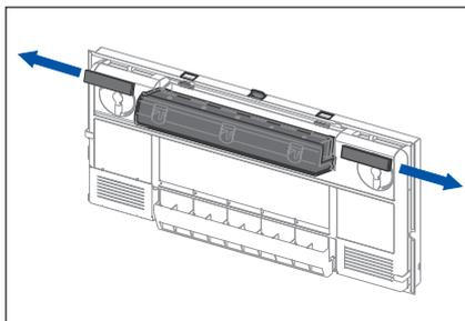
4. Die beiden verschmutzten Filter an den Seiten aus dem Filtergehäuse herauschieben.
