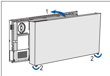
14. Die Abdeckung wiedereinssetzen und die Verriegelungshaken schließen (an der Unterseite oder den Seiten des Gehäuses).
