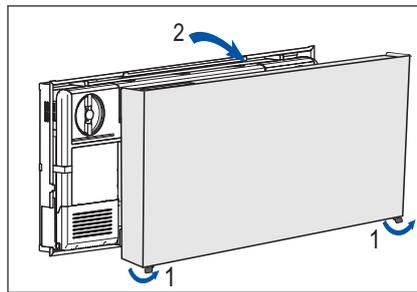
2. Die beiden Verriegelungshaken (an der Unterseite oder einer der Seiten des Gehäuses) öffnen. Die Abdeckung der Sensa durch Anheben entfernen.
