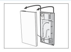
2. Die Abdeckung der Sensa durch Anheben entfernen.
