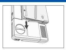
3. Den Filter an der linken Seite der Öffnung mit den Fingern herausziehen und entfernen.
