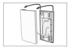
1. Die Abdeckung der Sensa durch Anheben entfernen.
