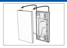
2. Die Abdeckung der Sensa durch Anheben entfernen.
