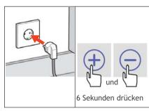
8. Den Stecker wieder in die Steckdose einstecken und den Stundenzähler des Filters zurücksetzen, indem Sie + und - auf dem Display gleichzeitig sechs Sekunden drücken. Die Meldung "Filter vervuild" verschwindet nun. Wichtig: Den Stundenzähler des Filters nur dann zurücksetzen, wenn Sie die Filter gewechselt haben.
