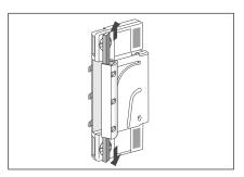
4. Die beiden verschmutzten Filterteile über die Ober- und Unterseite des Filtergehäuses entfernen.
