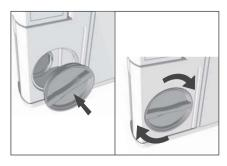
7. Die beiden Stopfen wiedereinsetzen und gut verschließen, damit das Gerät ordnungsgemäß funktioniert.
