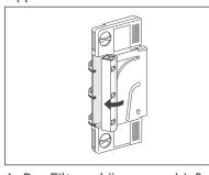
6. Das Filtergehäuse verschießen und mit den drei Verschlussklemmen befestigen.
