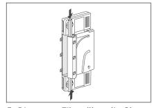
5. Die neuen Filter über die Oberund Unterseite vollständig in das Filtergehäuse hineinschieben.
