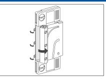
3. Die drei Verschlussklemmen an der linken Seite des Geräts öffnen und das Filtergehäuse nach vorne kippen.
