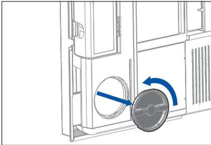
9. Reinigen der Luftkanäle. Die beiden Inspektionsluken nach links drehen und entfernen.
