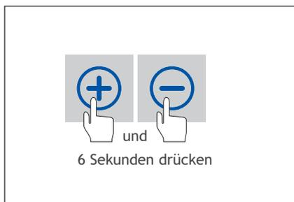
15. Den Stundenzähler des Filters zurücksetzen, indem Sie + und - auf dem Display gleichzeitig sechs Sekunden drücken. Die Meldung „Filter vervuild“ verschwindet nun.
