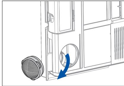
10. Die runden Einsätze aus dem Luftkanal entfernen und Staub und Schmutz aus dem Insektengitter entfernen.
