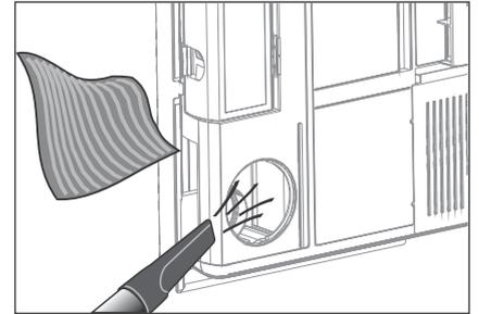
11. Mit einem Staubsauger oder einem weichen Tuch den Schmutz aus beiden Kanälen entfernen (kein Wasser verwenden).
