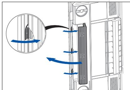
5. Das Filtergehäuse schließen und mit den drei Verschlussklammern verriegeln. Vorsicht! Die Filter dürfen nicht aus dem Filtergehäuse herausstehen.
