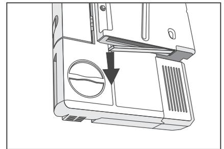
3. Den Filter an der linken Seite der Öffnung mit den Fingern herausziehen und entfernen.
