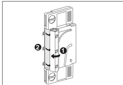
5. Das Filtergehäuse verschieben und mit den drei Verschlussklemmen befestigen.
