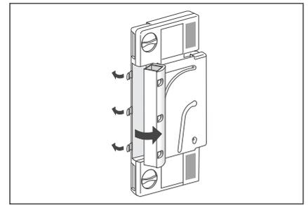
3. Die drei Verschlussklemmen an der linken Seite des Geräts öffnen und das Filtergehäuse nach vorne kippen.
