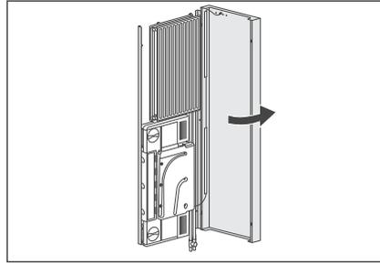
2. Die Tür des Gehäuses öffnen, indem Sie diese an der linken Seite ein klein wenig anheben und nach vorne ziehen.
