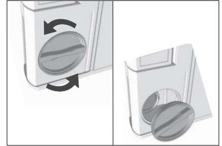
3. Die beiden Stopfen durch eine Drehung nach links lösen und herausnehmen.
