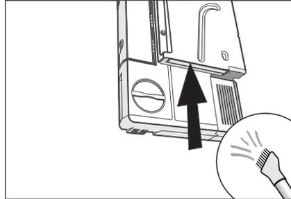
2. Verschmutzungen mit dem Staubsauger beseitigen. Dafür müssen Sie den Luftabfuhrfilter nicht herausnehmen.
